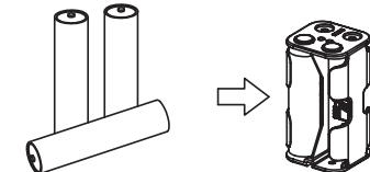
3. Вставьте батарейный блок на место и закройте крышку отсека батареек:
